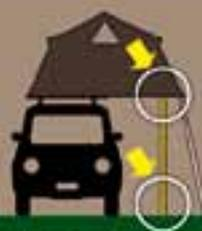
La stabilité de la structure repose sur un encombrant système de tubes télescopiques.
