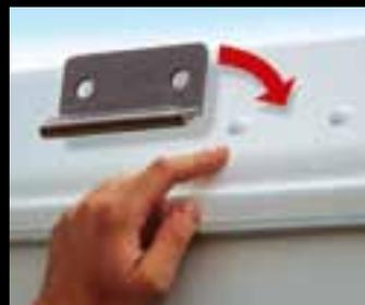
Kit Fix (art K/F) Les modèles Small et Medium sont étudiés pour l'accrochage de barres porte-charge supplémentaires (pour y mettre planches de surf, kayak et autres équipements). Le modèle Columbus Variant Small et Medium X-Long n'est pas prédisposé pour l'application du Kit Fix.
