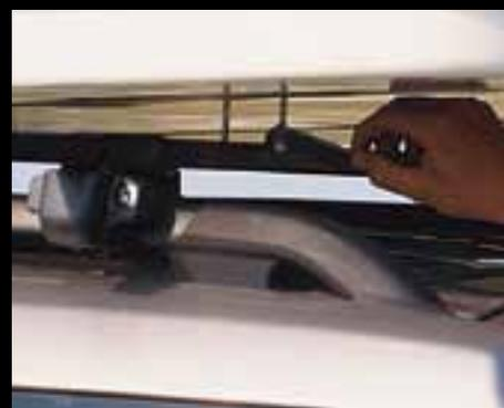
Des étaux coulissant dans des rails, livrés de série, permettent de fixer la tente au porte-charge. Le système est sûr et testé: aucune autre intervention n'est nécessaire.
