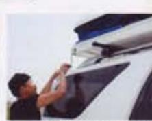
テントはハンドルを回して展開＆撤収。撤収時はテントが本体内にきれいに収まるよう手で押し込みながらとなるが、それでも慣れれば数分で完了
